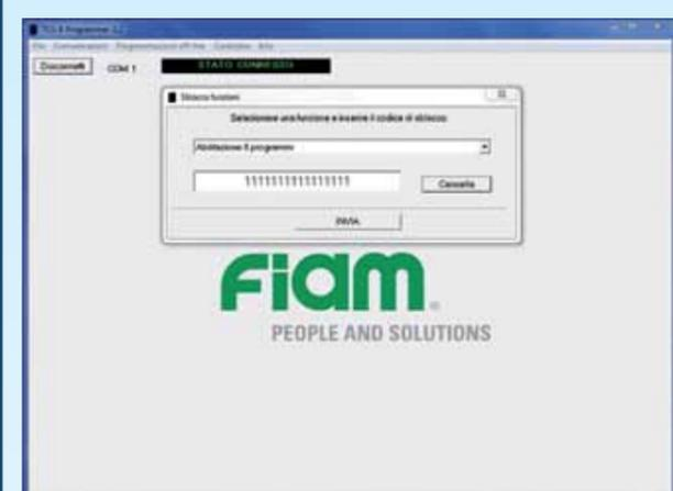
Le unità TCS-B E possono essere abilitate ad ulteriori 4 programmi di avvitatura (per un totale di 8 programmi). È sufficiente richiedere il codice di abilitazione che verrà fornito a parte. Cod. 686200904
