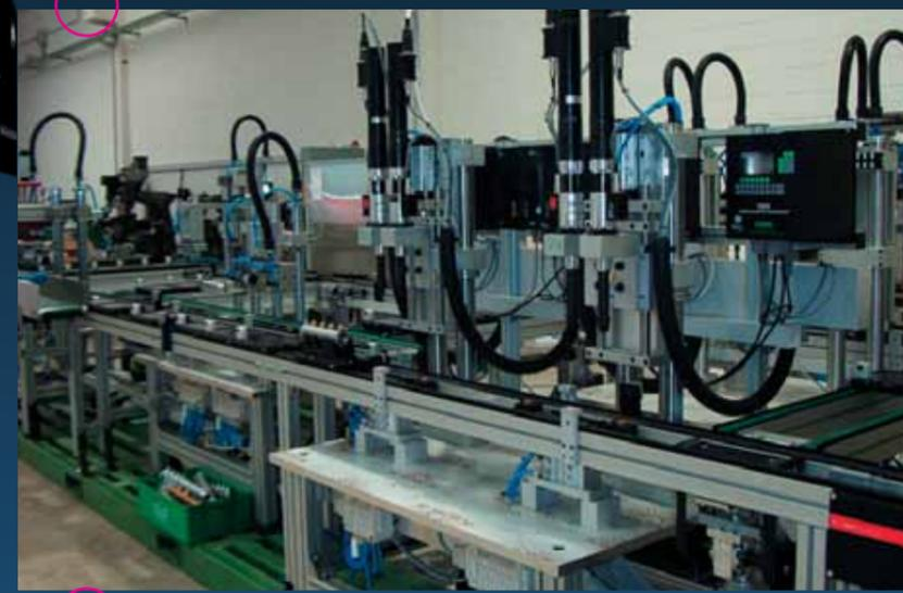
Linea automatica a pallets per collettori termoidraulici con postazioni di serraggio di viti di grandi dimensioni
