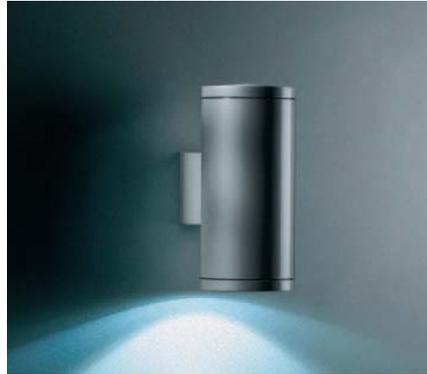
**Descrizione** Struttura in alluminio primario estruso e pressofuso ad elevata resistenza all'ossidazione. Riflettori in alluminio puro al 99.98%. Diffusore in vetro temprato di spessore 8 mm. Viti a brugola in acciaio INOX A4. Entrata cavi alimentazione con connettore rapido. Guarnizioni in silicone ricotto. Verniciatura in polveri poliestere ad elevata resistenza ai raggi ultravioletti ed alla corrosione.
