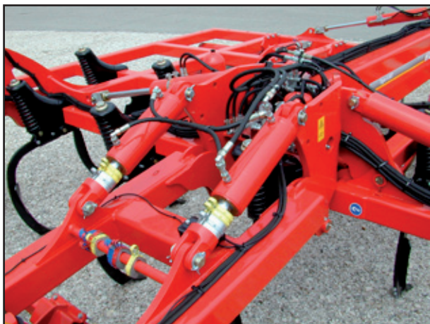
Clip in alluminio nei cilindri dei packer
