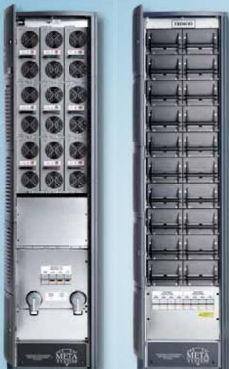
Il TRIMOD 45 kVA è costituito da un cabinet in cui si trovano 9 moduli di potenza da 5 kVA e da un cabinet batterie. Per ottenere lunghe autonomie si possono collegare altri cabinet batterie aggiuntivi.
