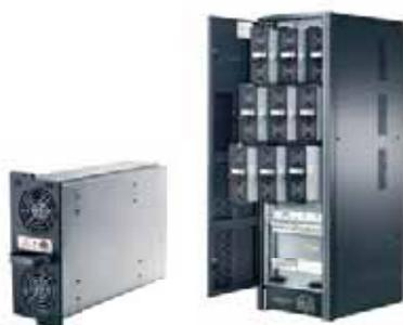
L'UPS TRIMOD ha una struttura modulare, è cioè composto da moduli elettronici di potenza (da 2,7 kVA, 3,4 kVA oppure 5 kVA) uguali tra loro intercambiabili e parallelabili. I moduli di potenza sono dotati di circuiti di controllo e di autodiagnostica al fine di rendere più semplice l'individuazione di un eventuale modulo guasto. Grazie a questa struttura modulare, risulta estremamente semplice configurare il TRIMOD come sistema N + X ridondante.
