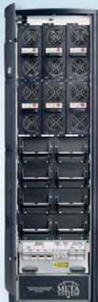
Il TRIMOD 16/20kVA è costituito da 6 moduli di potenza da 2,7/3,4 kVA e consente di alloggiare fino a 8 cassette batterie. Per ottenere lunghe autonomie si possono collegare cabinet batterie aggiuntivi.
