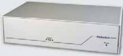
E' un dispositivo utilizzato per il controllo della distribuzione di energia e cioè permette di spegnere e accendere singolarmente i dispositivi ad esso collegati grazie alle quattro uscite di alimentazione indipendenti di cui è dotato.
