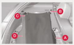
Fissare i ganci presso il pavimento (A).
