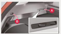
Posizionare un fermo posteriore presso (B) e portare il pulsante di bloccaggio in avanti. Bloccare gli altri tre allo stesso modo.
