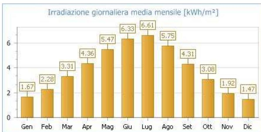
Fig. 1: Irradiazione giornaliera media mensile sul piano orizzontale [kWh/m<sup>2</sup>]- Fonte dati: UNI 10349 - Località di riferimento: SALERNO (SA)/AVELLINO (AV)
