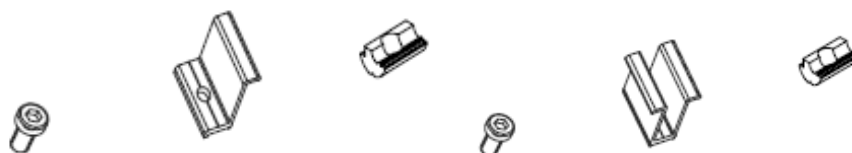
Figura 10 - Staffe in alluminio per il fissaggio moduli alla struttura di sostegno
