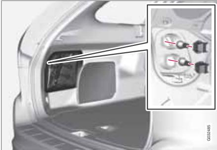
Le luci di arresto e di retromarcia si sostituiscono dall'interno del bagagliaio.
