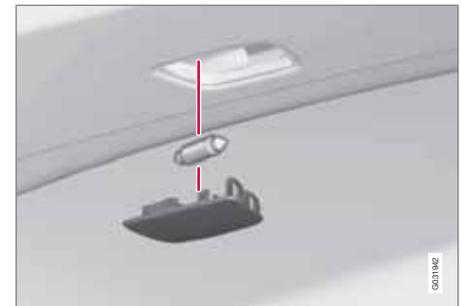
1. Inserire un cacciavite e fare leva leggermente per staccare l'alloggiamento lampadina.
