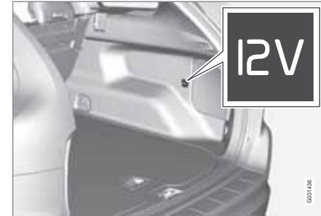
Abbassare il coperchio per accedere alla presa elettrica. La presa eroga tensione anche se la chiave telecomando non è inserita nel blocchetto di accensione.
