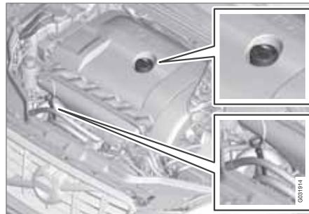
Asta di livello e tubo di rifornimento, motore a benzina.
