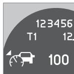
Il simbolo viene sostituito da quando il sensore radar rileva un veicolo.
