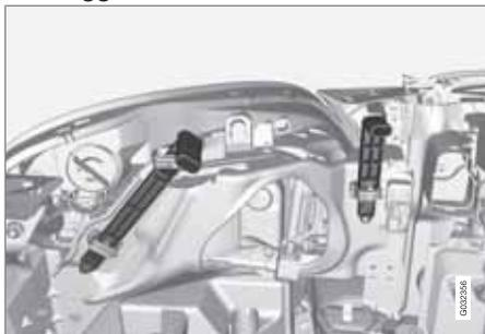
In sede di montaggio, verificare che il perno di bloccaggio lungo sia inserito correttamente in entrambi gli occhielli.
