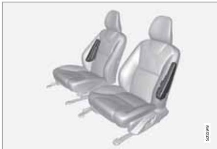
In caso di collisione laterale, la maggior parte della forza di collisione viene distribuita dal SIPS (Side Impact Protection System) alle traverse, ai montanti, al pavimento, al tetto e ad altre parti della carrozzeria. Gli airbag laterali dei sedili del conducente e del passeggero proteggono busto e fianchi e costituiscono una parte importante del SIPS.
