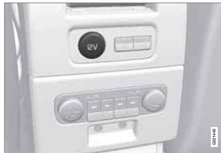
*Presenza da 12 V nel tunnel, sedile posteriore.*
