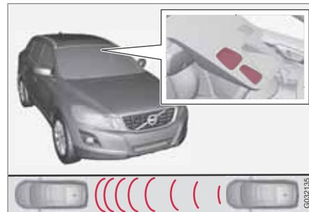
Finestre di trasmissione e ricezione del sensore laser.
