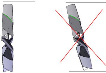
Verificare che la posizione di montaggio del ventilatore sia tale da mantenere la ventola in asse rispetto alle parti fisse
