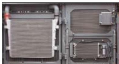
Invece che nel tradizionale schema allineato, il radiatore dell'olio e quello dell'acqua sono disposti separatamente in parallelo, per agevolarne lo smontaggio. Questa nuova disposizione semplifica sensibilmente gli interventi di pulizia nell'area del radiatore dell'acqua e dell'olio, migliorando la capacità di raffreddamento dell'olio.
