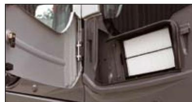
I filtri per l'aria esterna del climatizzatore sono stati spostati e invece che alle spalle del sedile dell'operatore si trovano sul lato dello sportello in cabina. In questo modo è facile pulire e sostituire i filtri, ad esempio quelli di circolazione dell'aria all'interno della cabina.
