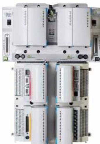
Figura 2.6: CPU e quattro schede Emerson Ovation
