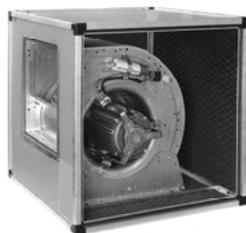
Ventilatore centrifugo cassonato a doppia aspirazione, motore direttamente accoppiato alla girante con pale in avanti. Temperatura massima 40°C.
