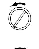
Ruotando la manopola completamente in senso ANTI-ORARIO si ottiene la temperatura minima di intervento del termostato (50°C)
