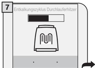
Die Maschine beginnt mit der Ausgabe der Entkalkungslösung über die Ausgabedüse des heißen Wassers. Die Ausgabe erfolgt in voreingestellten Intervallen, um die optimale Wirkung der Lösung zu gewährleisten.
