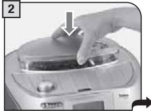
Den Deckel zum Schließen bis zum Anschlag nach unten drücken.
