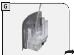
Inserire la soluzione decalcificante nel serbatoio. Riporre quest'ultimo nella macchina.
