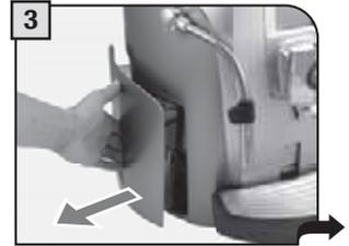
Den Wassertank herausnehmen. Es wird empfohlen, den Wasserfilter „Aqua Prima“ zu installieren (siehe Seite 7).
