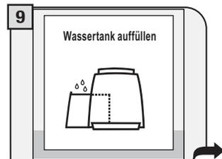
Den Wassertank herausnehmen und mit frischem Trinkwasser ausspülen, um die Entkalkungsmittelrückstände vollständig zu entfernen. Den Behälter anschließend mit frischem Trinkwasser füllen.
