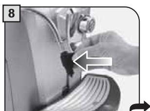
Die Halterung der Dampfdüse herausnehmen und reinigen. Danach wieder einsetzen.
