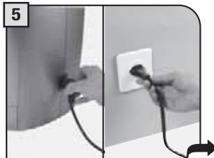
Den Netzstecker in den vorgesehenen Anschluss auf der Maschinenrückseite, das andere Ende in eine geeignete Steckdose (siehe Typenschild) einstecken.
