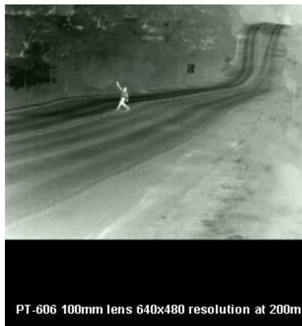
Figura 49: Risoluzione termocamera PT 606 ad una distanza di 200 metri.
