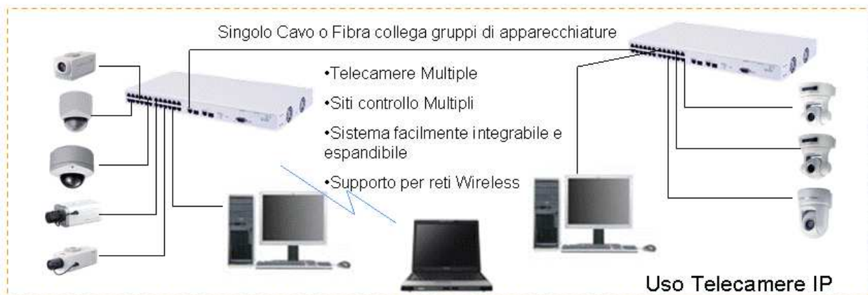
Figura 36: Struttura di un sistema di videosorveglianza con telecamere IP.
