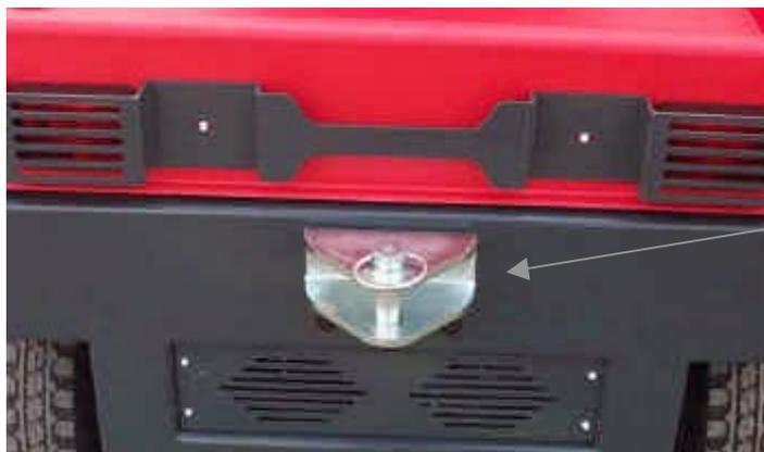
**Gancio di traino:** va collegato il braccio di traino del carrello da trainare. Per agganciare il carrello è necessario togliere il perno infilato nel supporto, avvicinarsi il veicolo al carrello, inserire il braccio di traino del carrello e reinserire il perno.
