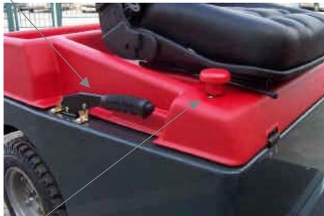
**Pulsante di emergenza:** va premuto nelle situazioni d'emergenza in quanto arresta l'alimentazione della macchina. Quando si lascia il veicolo in sosta è buona norma premerlo. Dopo averlo premuto, qualora si desideri riprendere le normali funzioni della macchina, ruotare il pulsante.
