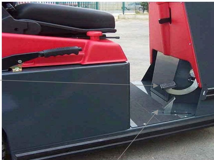
**Pedale acceleratore:** il pedale acceleratore è posto alla destra del pedale del freno. Esso è del tutto simile a quello delle automobili, schiacciando il pedale si alimenta il motore in maniera progressiva. Quindi con il pedale completamente schiacciato, il motore eroga la massima potenza, appena schiacciato la minima. Si ha il medesimo controllo per entrambi i sensi di marcia.
