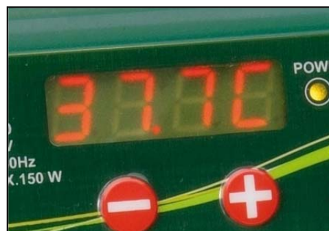
Display con temperatura interna del momento (temperatura seguita da "C")
