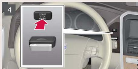
**4** Premere il pulsante **START/STOP/ENGINE** per accendere il motore<sup>B</sup>.
