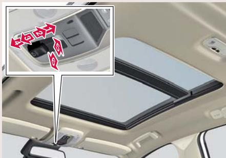
Alla prima pressione del comando si aziona la tendina parasole, alla seconda il tettuccio panoramico. In caso di azionamento manuale del tettuccio, la tendina parasole deve essere completamente aperta. In posizione di ven-
