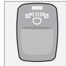
Se l'automobile è dotata di fari Active Xenon (ABL, Active Bending Lights), la luce dei fari segue i movimenti del volante durante la guida. La funzione si attiva automaticamente all'accensione dell'automobile e può essere disattivata/attivata premendo il pulsante. La spia sul pulsante è accesa quando la funzione è attivata.
