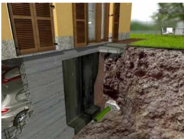
Al piede delle fondazioni per raccogliere l'acqua in eccedenza dovuta alle piogge, evitando che ristagni con possibilità di infiltrazioni, verrà posta in opera una tubazione microforata drenante (protetta con tessuto per evitare che si sporchi di terra) che convoglierà le acque raccolte entro un pozzo di sollevamento e le conferirà, mediante pompa elettrica o per caduta naturale, nelle condotte fognarie.
