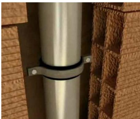
Le colonne di scarico, realizzate in materiale silenziato, sono posate all'interno delle murature e fissate a mezzo di collarini in gomma antivibrante che attenuano ulteriormente i rumori.
