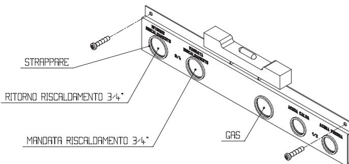
Per il montaggio della piastra di supporto della caldaia, usare come riferimento la fascia in lamiera a questa collegata (vedi figura).
