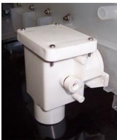
Tale valvola è stata appositamente studiata dovendo poter scaricare acqua e pezzi di calcare senza doversi ostruire e dovendo essere in grado di scaricare anche senza pressioni all'ingresso.
