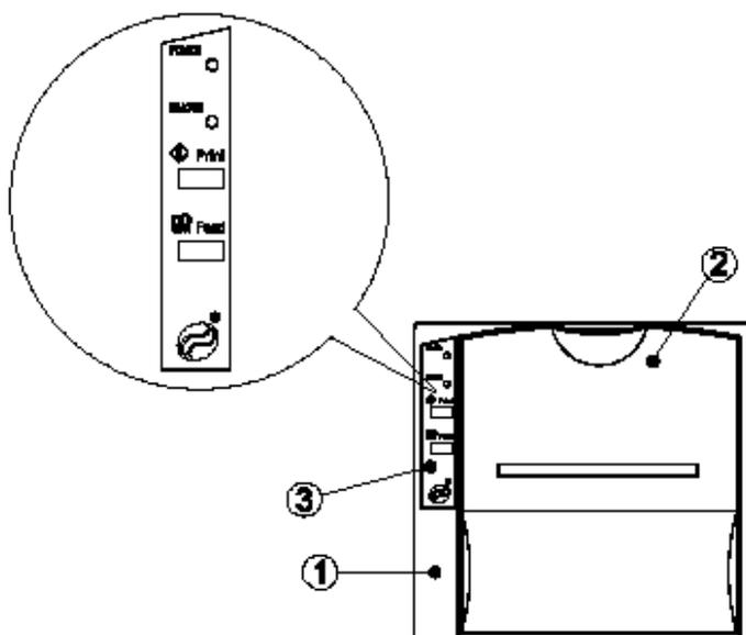
Tasto PRINT. Quando viene azionato provoca sulla seriale la trasmissione del carattere di controllo "\$0D" solo se è stato abilitato nel setup della stampante.
