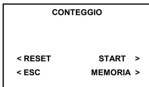
c . Premendo RESET si effettua il reset della macchina, il piatto di caricamento (5) esegue un giro in senso inverso e si visualizza il seguente menù:
