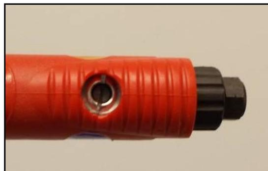
Figura 8 – Regolazione velocità.
