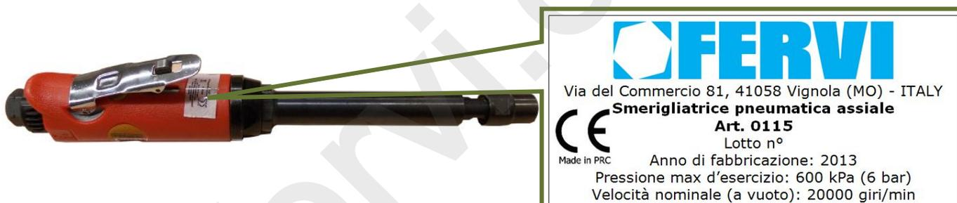
Figura 3 – Dettaglio targhetta di identificazione
