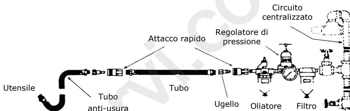
Figura 4 - Collegamento dell'alimentazione pneumatica
