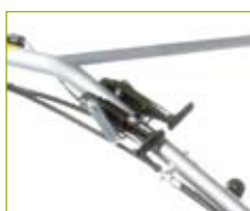
Differenziale con leva di sbloccaggio sul manubrio.
