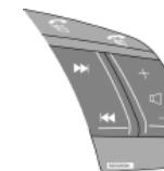
Il nastro viene avvolto rapidamente in avanti se si preme e si mantiene premuto il tasto ed all'indietro con . Nel display viene visualizzato "FF" (avanti) o "REW" (indietro) durante l'avvolgimento rapido. L'avvolgimento rapido si interrompe se si preme di nuovo il tasto.
