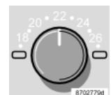
Usando i due volantini è possibile impostare la temperatura per il lato conduttore e quello del passeggero. Ricordare che riscaldamento e raffreddamento non sono più rapidi anche se si sceglie una temperatura più alta o più bassa di quella desiderata nell'abitacolo.
