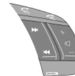
Se il volante è dotato di tastiera, premere le frecce di sinistra o destra per selezionare le stazioni preprogrammate.
