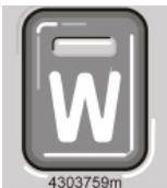
Con il tasto **W**<sup>5</sup> a lato della leva selettrice si inserisce e disinserisce il programma invernale **W**. Nel quadro comandi combinato viene visualizzato il simbolo **W** quando il programma invernale è attivato.
