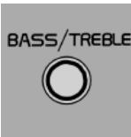
Impostare gli alti premendo la manopola, estraendola ulteriormente e ruotandola verso destra o sinistra. Nella posizione centrale gli alti sono "normalizzati".
