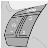
I comandi del regolatore elettronico della velocità si trovano sulla parte superiore sinistra del volante.
