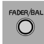
Impostare il bilanciamento premendo ed estraendo la manopola e ruotandola verso destra o sinistra. Nella posizione centrale il bilanciamento è "normalizzato".
