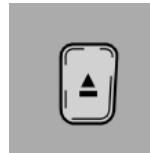
Premendo il pulsante, il nastro si ferma e la cassetta viene espulsa. Per selezionare una nuova sorgente di programma, ruotare il volantino
