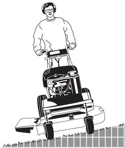
Si potrebbero soffrire lesioni gravi se si usa questa unità su terreno in pendenza eccessiva. L'uso dell'unità su terreno in pendenza eccessiva su cui può non esserci adeguato appiglio per i piedi e trazione (o controllo) per l'unità può causare la perdita di controllo e la possibilità di slittamento, caduta o rovesciamento dell'unità.
