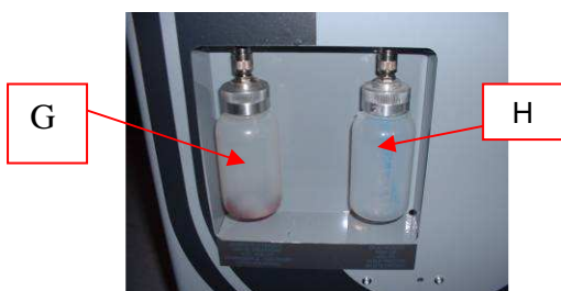
Fig. 7 - Dosatori olio: esausto (G) -fresco (H)
