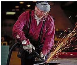
Trattasi della saldatura o taglio di parti metalliche mediante cannello ossiacetilenico
