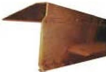
Trattasi della posa in opera di scossaline, presagomate in officina o costruite in stabilimento, di qualsiasi materiale, quali acciaio, lamiera zincata o preverniciata, alluminio, rame, per la copertura di parapetti, muretti, cornicioni, camini e lucernari, al fine di assicurarne l'impermeabilizzazione. L'ancoraggio delle scossaline alle strutture portanti è realizzato mediante apposite viti e tasselli.
