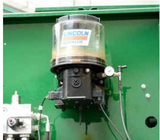
Il tempo preimpostato di lubrificazione può essere forzato attraverso il comando situato in cabina (pulsante "A"). Indipendentemente dai tempi preimpostati sulla pompa centralizzata, alla pressione del pulsante la pompa provvederà ad erogare il lubrificante presso i punti di lubrificazione ad essa collegati attraverso uno o più distributori.
