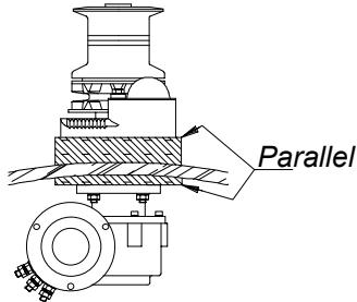
Le modèle ALBATROS est constitué de pièces sur le pont, poupée (362), barbotin (367) et base, et de pièces sous le pont moteur électrique et transmission. Séparer les éléments sur le pont des éléments sous le pont. Dévisser et retirer les écrous (391) des tiges filetées (389).
