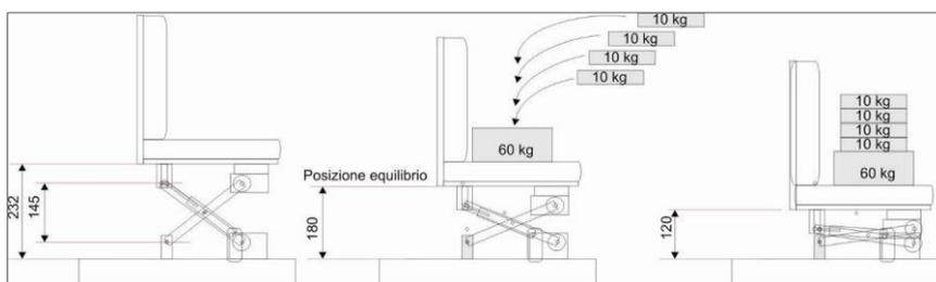
Figura 5 - Prove al banco per la determinazione delle caratteristiche geometriche e dinamiche del sistema ammortizzante del sedile.
