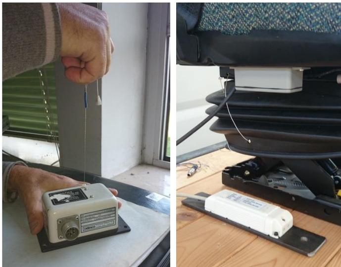
*Figura 4 – A sinistra: trasduttore di posizione a filo; a destra: accelerometri estensimetrici applicati al sedile e al pianale del trattore*
