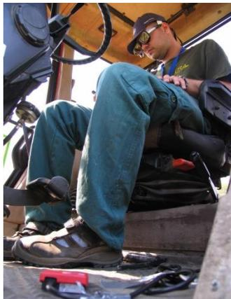
*Figura 1 – Catena strumentale utilizzata per la valutazione del carico di lavoro mentale: in primo piano il pedale collegato ad uno smartphone per la valutazione del “doppio compito”; indossati dall’operatore gli occhiali per il tracciamento oculare.*
