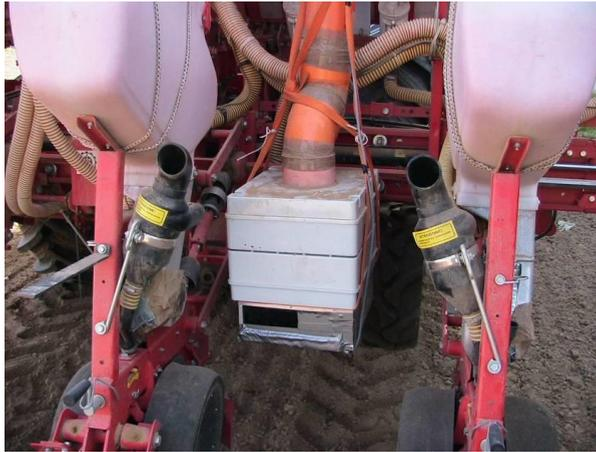
Figura 2 – Modifica M2: filtro elettrostatico applicato a valle del filtro antipolline per catturare la frazione residua nell'aria in uscita.
