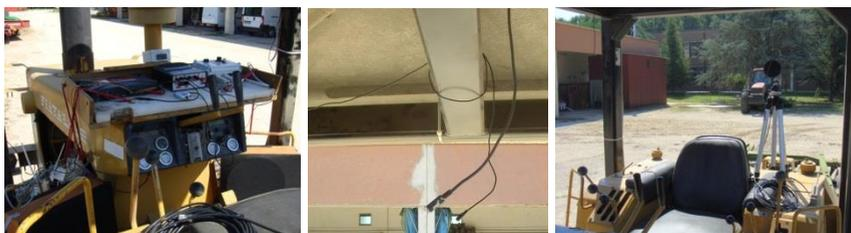
Figura 22 – Prove con l'ANC sul Fiat Allis 150. Da sinistra: consolle sul quadro comandi con ANC e amplificatore e, in basso, sui due lati, le casse acustiche; coppia di microfoni electret sospesi in corrispondenza della testa del conducente; microfono per le misure spettro-fonometriche.
