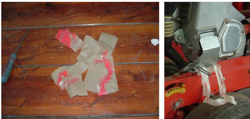
Figura 18 - Sinistra: nastro usato per sigillare la zona di applicazione della flangia di supporto dei deflettori sulla bocchetta del ventilatore; destra: nastro applicato alla bocchetta d'ispezione di un distributore. In entrambi i casi è visibile la polvere trattenuta.
