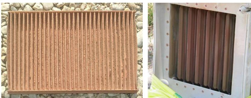
Figura 7 – Prove di semina con seminatrice modificata. A sinistra: filtro antipolline (è presente una notevole quantità di polvere derivante dal terreno). A destra: filtro elettrostatico, che si è dimostrato efficace nel trattenere la frazione più sottile di polvere sfuggita al filtro antipolline.
