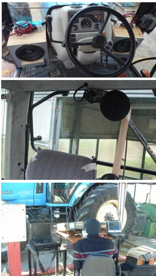
*Figura 23 - Organizzazione delle prove con l'ANC su trattore al freno dinamometrico (a destra). Dall'alto: le due casse ad elevata efficienza posizionate ai lati del quadro comandi; due microfoni electret ai lati del poggiatesta e microfono per misure spettro-fonometriche; postazione di controllo dell'ANC e del sistema di analisi Soundbook.*
