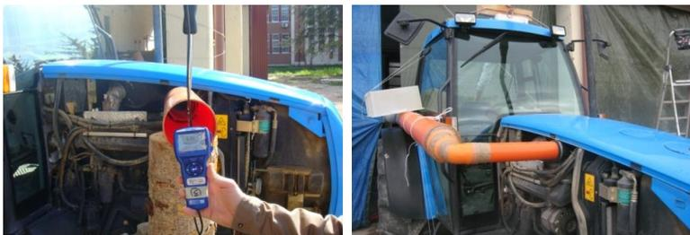
Figura 24 – Test relativi al montaggio del condotto dalla seminatrice al motore del trattore. A sinistra, rilievi della portata dell'aria; a destra, tubo di alimentazione dell'aria.
