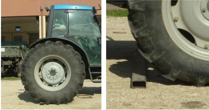
Figura 6 - Prove su tracciato a risalti per la caratterizzazione della risposta del sistema ammortizzante del sedile alle vibrazioni indotte dal passaggio sui risalti stessi.
