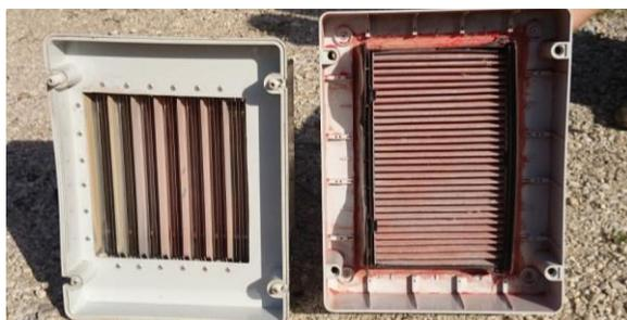
Figura 25 – I filtri (parte interna) dopo le prove con thiacloprid. A sinistra, filtro elettrostatico; a destra, filtro APF. Su entrambi il deposito della polvere di seme conciato.
