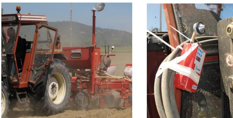
*Figura 9 – Semina in campo (notare la cabina del trattore aperta); a destra, particolare del posizionamento del campionatore in prossimità della cabina.*
