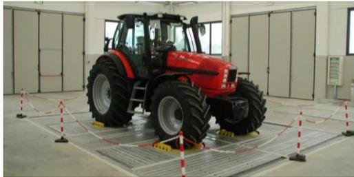
*Figura 1 - Il banco “four poster” usato per la riproduzione delle dinamiche registrate (il trattore in foto è solo d’esempio).*
