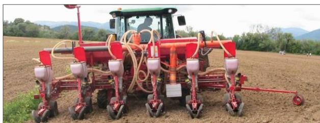
Figura 1 – Modifica M1 con sistema di ricircolo e filtrazione dell’aria in eccesso tramite filtro anti-polline a carboni attivi (scatola grigia alla fine del tubo collettore verticale).
