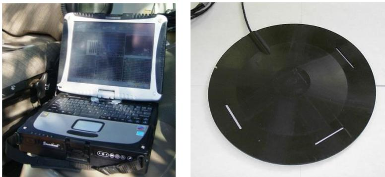
Figura 2 – A sinistra: Soundbook-acquisitore/elaboratore di segnale ad otto canali con speciale software “Samurai”; a destra: accelerometro triassiale da sedile per il rilievo delle accelerazioni al corpo intero.
