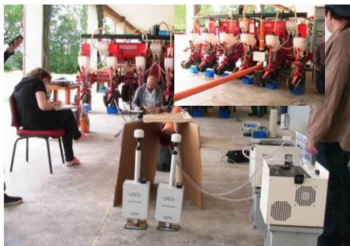
Figura 10 – Prove a punto fisso con campionamenti d’aria multipli con pompe, impattore e sonda “laser scanner”.
