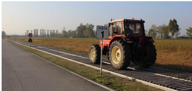
*Figura 3 – La pista a risalti ISO 5008:2012 del CRA-ING di Treviglio realizzata nell'ambito del Progetto INTRAC.*
