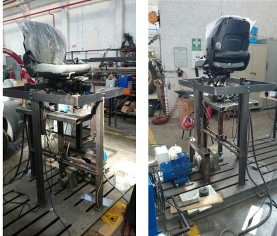
*Figura 20 - Banco prova allestito per i primi test sul sedile equipaggiato con il prototipo di apparato per il controllo attivo delle vibrazioni.*
