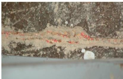
Figura 17 - Particelle e polvere da abrasione accumulate sulla superficie sotto la seminatrice in prova in corrispondenza del ventilatore centrifugo.
