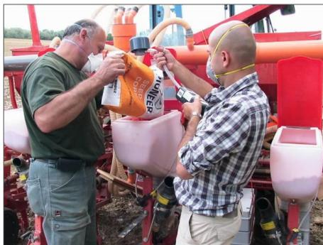
Figura 5 – Campionamento d'aria durante il riempimento delle tramogge.
