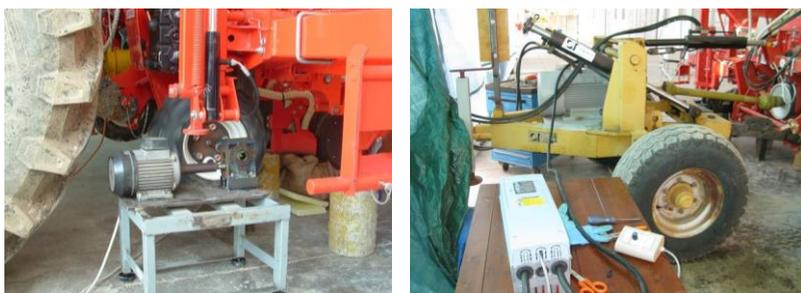
Figura 15 – Sinistra: Motore elettrico e inverter per azionare la ruota motrice; Destra: motore elettrico ed inverter per azionare il depressore.
