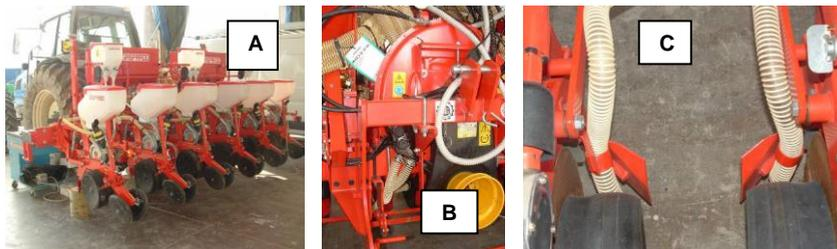
Figura 16 – A) seminatrice usata nelle prove; B) particolare del ventilatore con bocchetta rivolta verso il basso sulla quale è applicata la modifica di cui sono visibili due dei quattro tubi deflettori; C) due dei quattro tubi deflettori che terminano dietro gli assolcatori.
