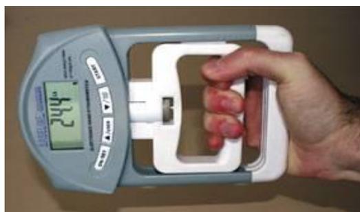
Figura 3 - Dinamometro digitale per il rilievo dell'hand grip
