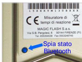
Accendere lo strumento “**ON**”, Alimentare il Bluetooth “**UP**”, Inviare i dati all'esterno “**SEND DATA**”. La spia **blu** posta sul fondo dello strumento (in basso a sinistra della targhetta identificativa) lampeggerà in fase di ricerca del collegamento ed emetterà luce fissa a collegamento avvenuto.
