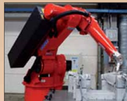
Figura 14 - Robot antropomorfo per la saldatura laser (sorgente \text{CO}_2 ).
