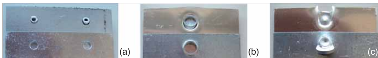
Figura 9 - Esempi di frattura di giunti rivettati (a), clinciati (b) e SPR (c).
