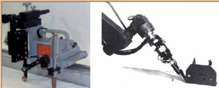
Figura 7 - Sistemi di controllo del giunto (seam tracking) a contatto: a rotella (sinistra) e a puntale (destra).
