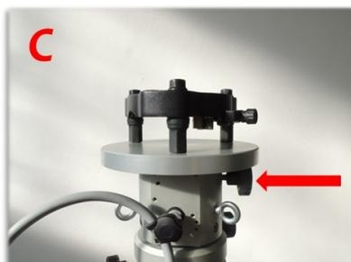
inserirla nella testa della struttura serrando la vite di blocco
