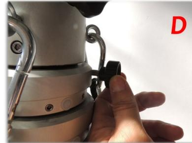
Aprire completamente il blocco meccanico della prima estensione (sotto la testa)
