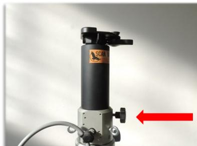
Inserire l'adattatore sulla testa della struttura e serrare la vite di blocco
