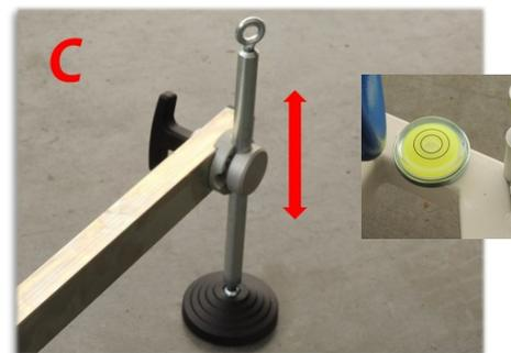
Tramite i piedi regolabili livellare la struttura, controllando la bolla sferica posizionata sul telaio.
