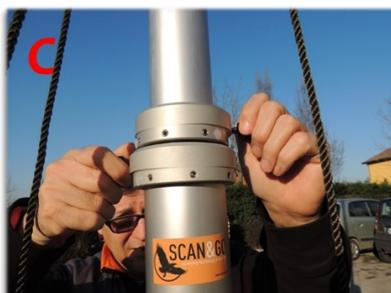
Chiudere il blocco meccanico della prima estensione e aprire il blocco della seconda estensione
