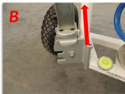
Sfilare verso l'esterno i pattini di fissaggio e ruotare gli stabilizzatori fino allo scatto di chiusura dei pattini.
