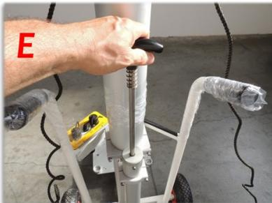
Utilizzando la pompa a mano far uscire completamente la prima estensione
