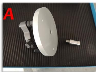
Se utilizzate il tricuspid con viti calanti bloccate, inserire il perno con filetto 5/8" maschio
