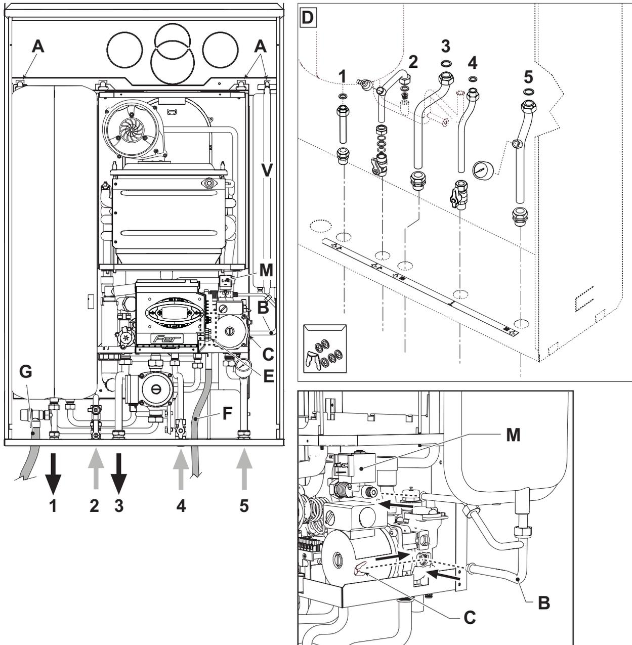
fig. 18 - Collegamento attacchi idraulici e gas / Kit tubi attacchi
