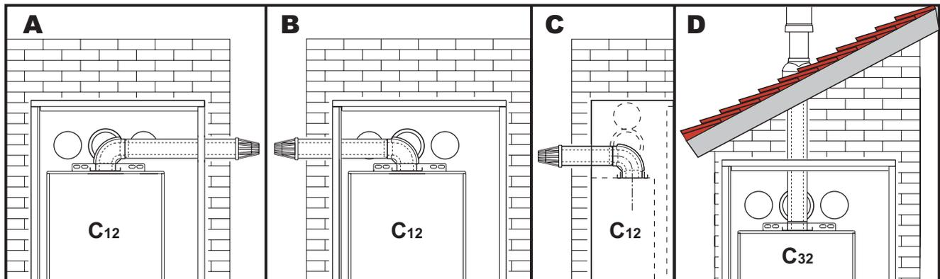
fig. 21 - Esempi di collegamento con tubi coassiali
