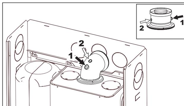
fig. 31 - Analisi della combustione
