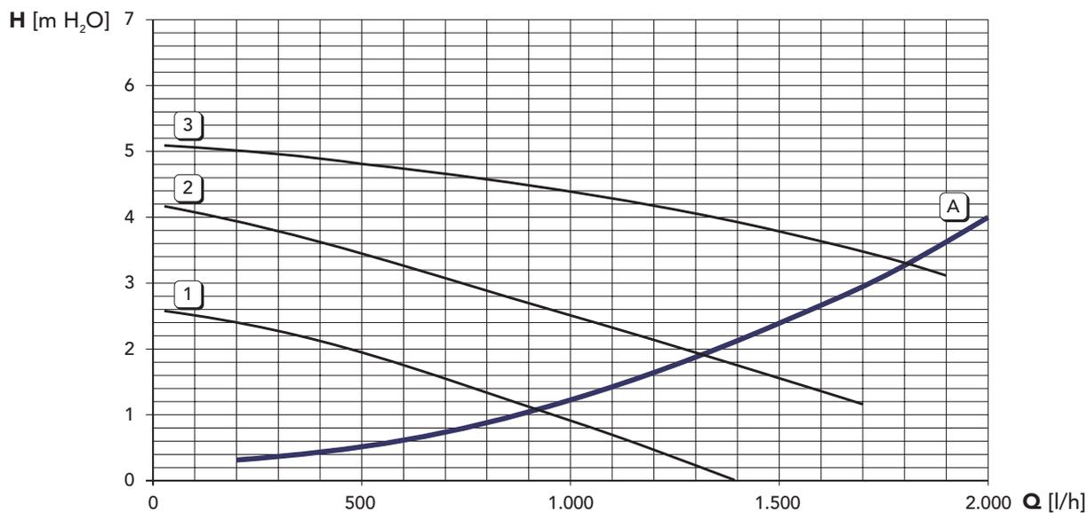
**A** Perdite di carico caldaia
