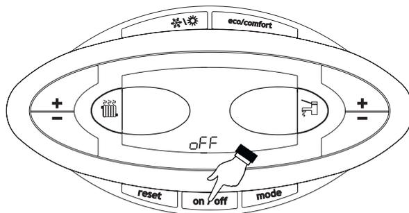
fig. 6 - Spegnimento caldaia
