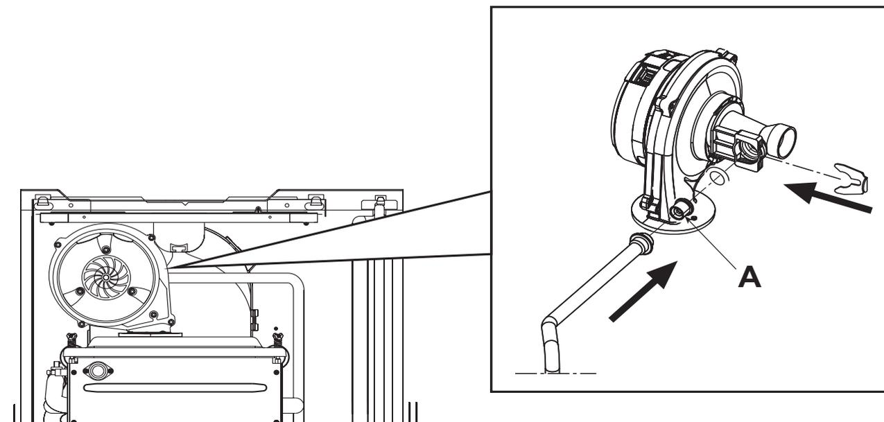
fig. 28 - Sostituzione ugello gas
