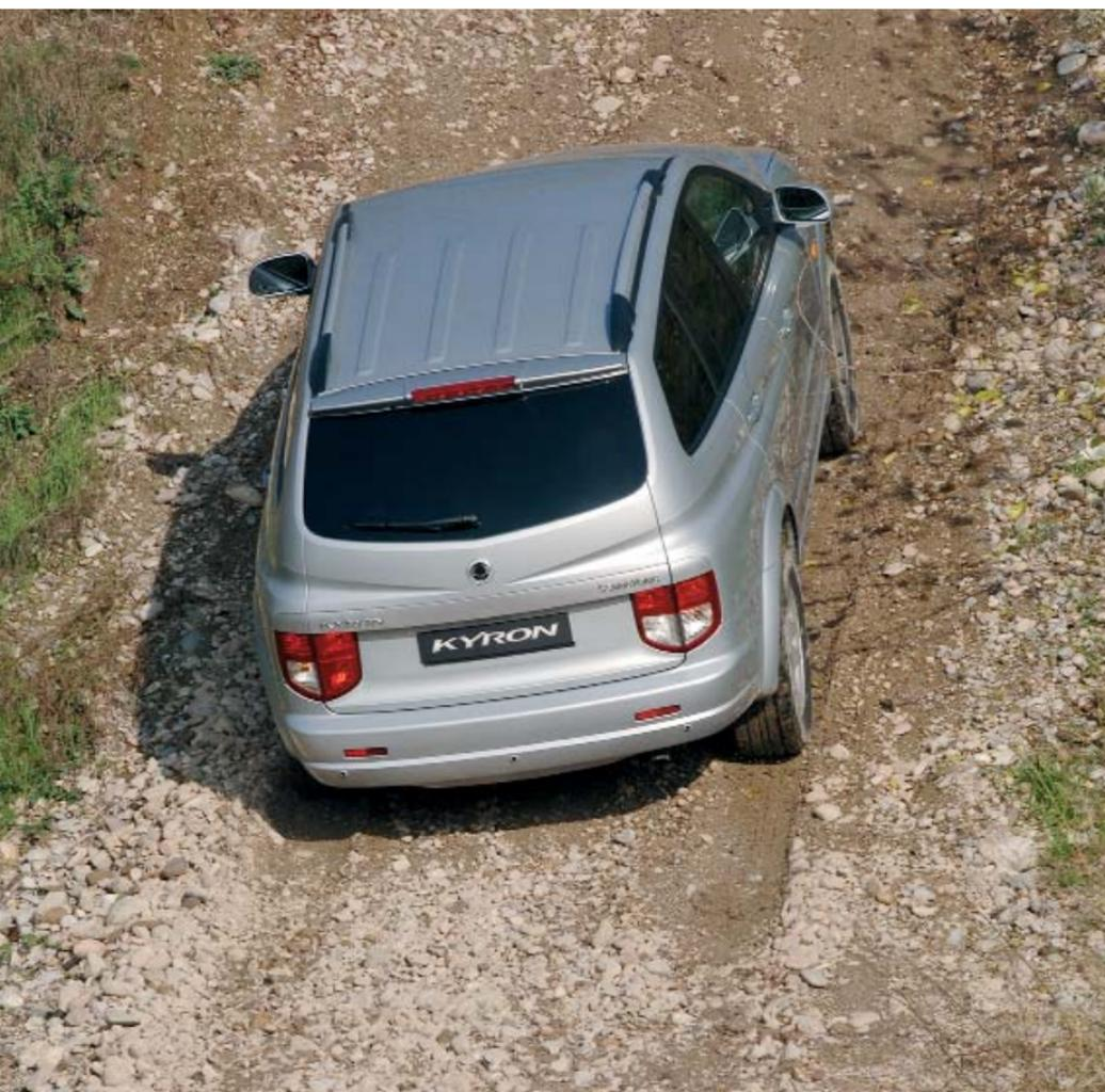
lo in caso di solchi particolarmente profondi occorre cercare, quando è possibile, percorsi alternativi per evitare di abbassare la minima distanza da terra fino a spanciare con il fondo vettura sul terreno.
