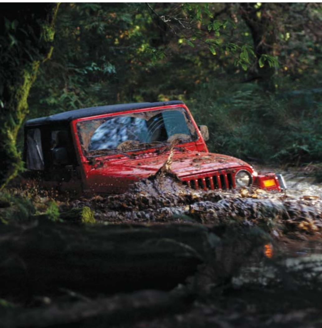
punto di entrata poiché in presenza di un angolo molto ripido la ventola viene a trovarsi subito immersa nell'acqua, spruzzando acqua all'interno del vano motore prima ancora che il veicolo abbia assunto la posizione orizzontale.
