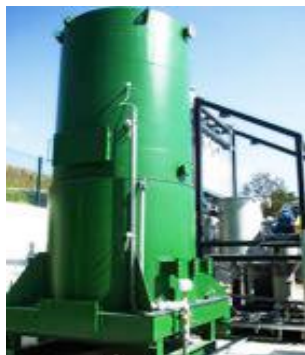
Foto 2 Reattore di gassificazione
