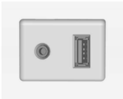
Questo veicolo è dotato di presa AUX e di presa USB nella consolle centrale per il collegamento di fonti dati audio esterne.
