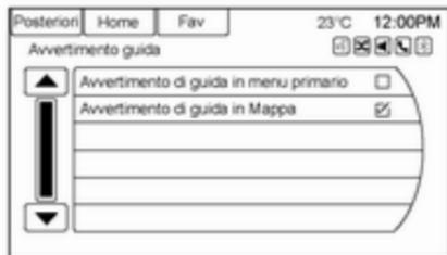
Premere per attivare la visualizzazione dell'avviso di guida sulla mappa o sulle schermate principali, ad es. audio, telefono ecc. Compare un segno di spunta per indicare l'attivazione della modalità dell'avviso di guida.
