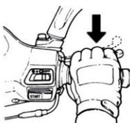
**ATTENZIONE:** La versione ABS non è dotata di frenata combinata: pertanto, la leva di destra azionerà solo l'impianto freno anteriore, la leva di sinistra azionerà il solo impianto posteriore.
