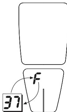
**fig. 15 - Anomalia pressione impianto insufficiente**
