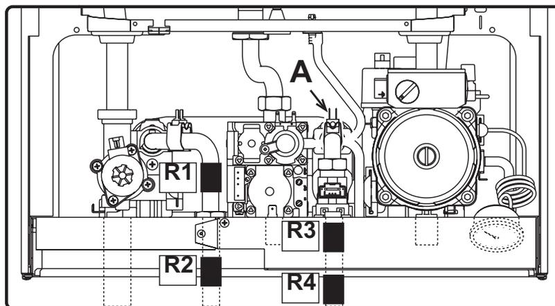
fig. 17 - Posizionamento riscaldatori e termostato antigelo
