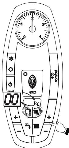
fig. 21 - Modalità TEST (potenza riscaldamento = 100%)
