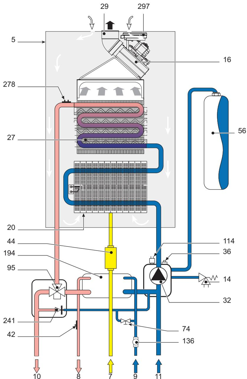
fig. 27 - Circuito idraulico
