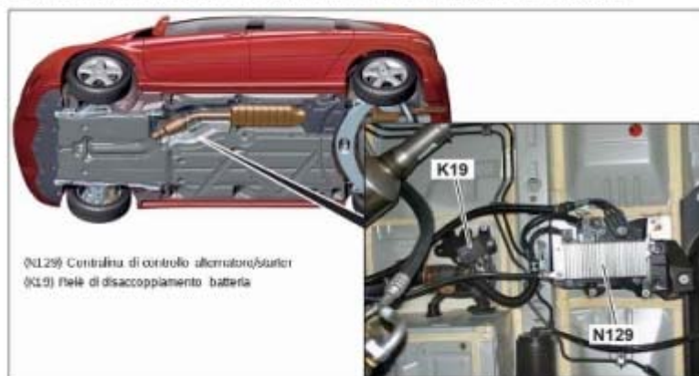
Posizioni di montaggio centralina e disaccoppiatore batteria
