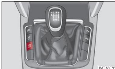
Fig. 2 tasto del sistema START-STOP
