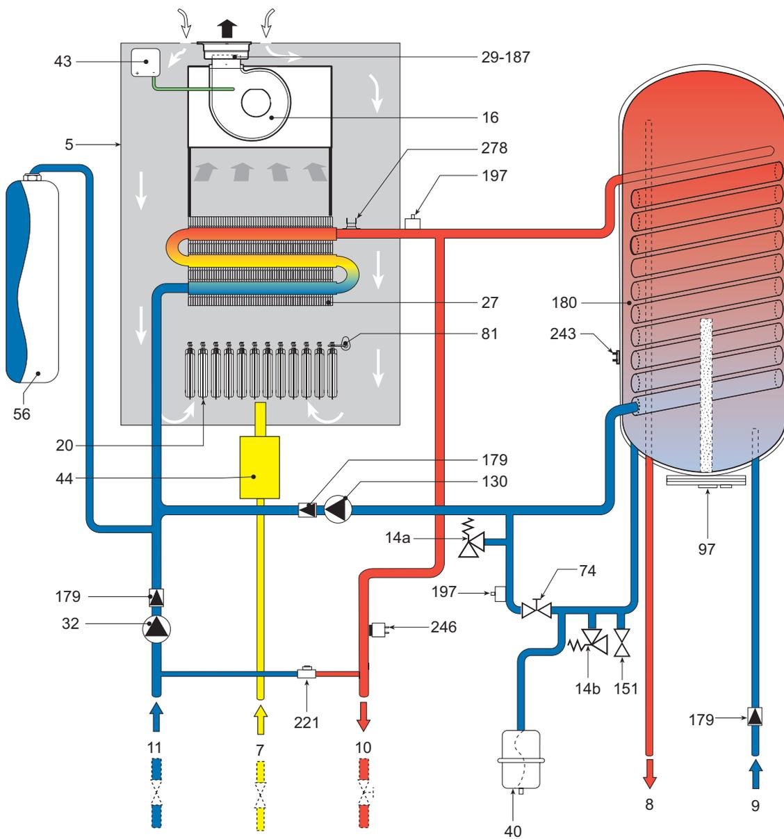
**fig. 32 - Circuito idraulico**
