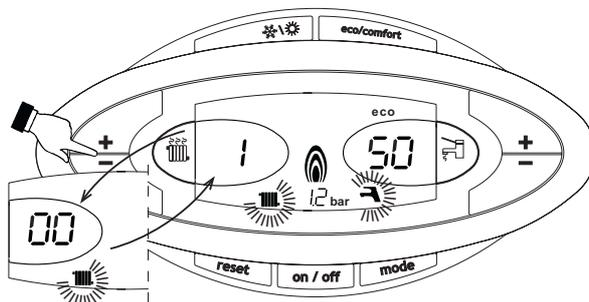
fig. 26 - Modalità TEST (potenza riscaldamento = 100%)
