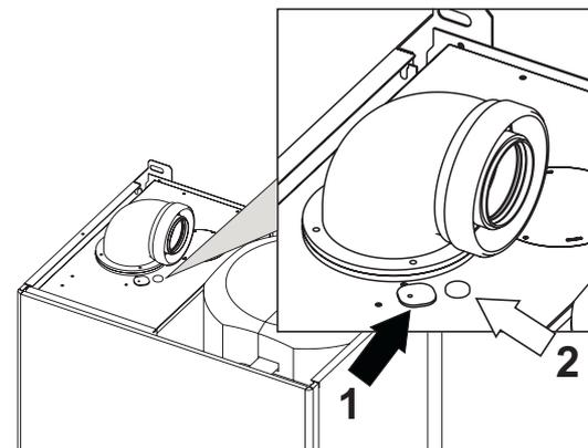
fig. 29 - Analisi combustione
