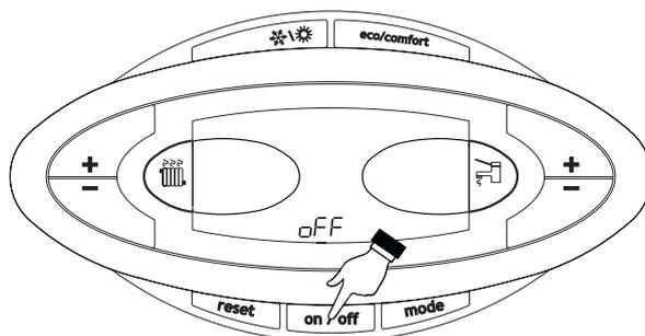
fig. 6 - Spegnimento caldaia
