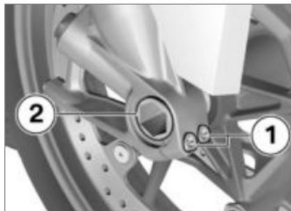
**!** La vite di bloccaggio asse sinistra fissa la boccola filettata nella guida della ruota anteriore.
