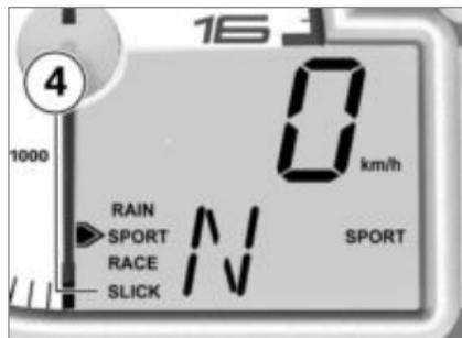
Con connettore di codifica montato, il menu di selezione mette inoltre a disposizione la modalità di marcia **SLICK 4**.
