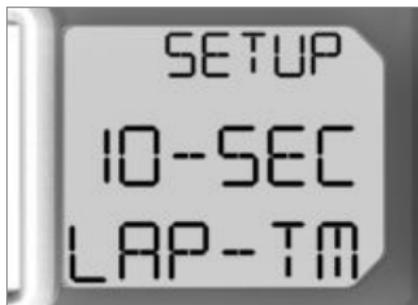
Qualora s'impieghi un ricevitore agli infrarossi per rilevare la durata del giro, è possibile impostare il tempo che deve trascorrere dopo il segnale ricevuto per primo, prima che venga accettato un nuovo segnale. In tal modo si evita di valutare i segnali di più trasmettenti posizionate l'una accanto all'altra.
