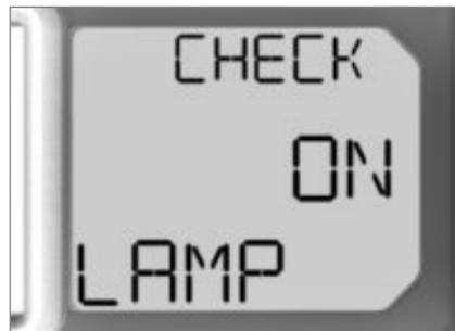
Se per l'esercizio sul circuito di gara si elimina una lampadina o si smonta il portatarga, l'elettronica del veicolo riconosce questo fenomeno come lampadina guasta e visualizza il messaggio corrispondente sul display. Con questa funzione si sopprime la visualizzazione.
