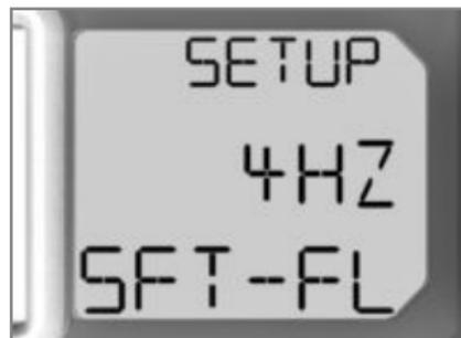
Frequenza del lampeggio della spia di cambio marcia e dell'avviso di velocità in Hz (1/s). Se si seleziona ON, la spia di cambio marcia e l'avviso di velocità si accendono in modo costante.
