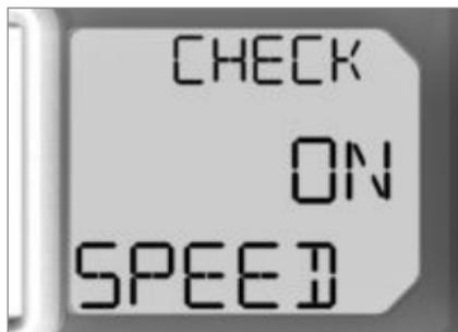
Attivando questa funzione, si attiva anche un menu principale supplementare in cui è possibile stabilire la velocità massima. Se la velocità del veicolo supera questo limite, appare un avviso.
