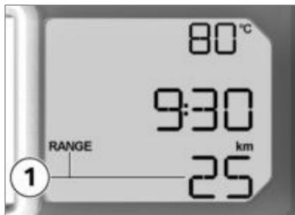
L'autonomia **1** segnala quale chilometraggio è ancora possibile effettuare con la quantità residua di carburante. Viene visualizzata solo una volta raggiunta la riserva di carburante. Il calcolo si effettua in base al consumo medio e al livello di carburante.
