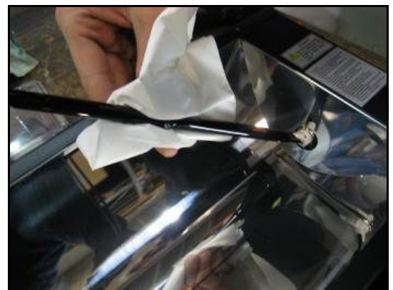
Figura 7 – Rimozione del bulbo.
