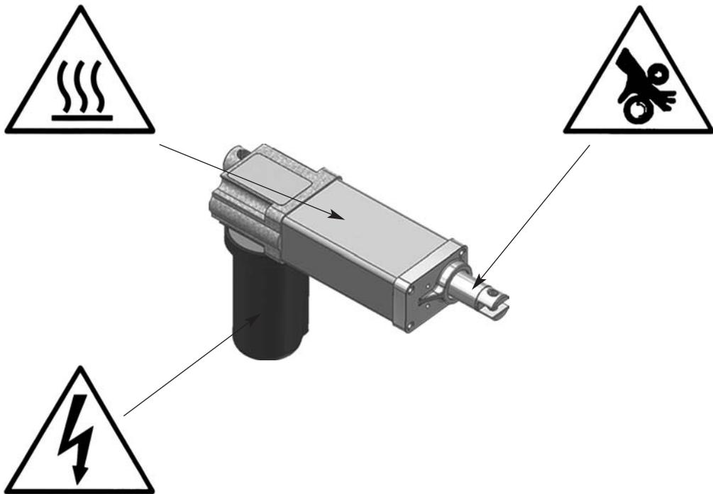
Indicazione delle parti soggette a rischio residuo di parti in tensione, superfici a rischio di surriscaldamento, possibili punti di impigliamento.
