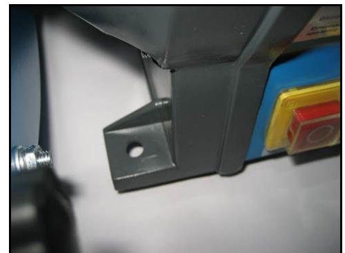
Figura 4 – Dettaglio foro di fissaggio
