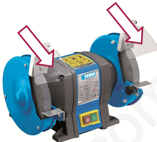
Figura 5 – Dettaglio schermi di protezione.
