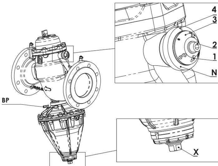
**IMPORTANTE:** Se la differenza di pressione che si stabilisce sui due lati della membrana è eccessiva, può portare al danneggiamento della membrana stessa e di altri componenti, compromettendo la funzionalità della valvola.
