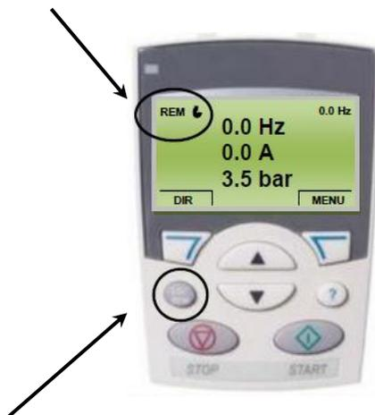
Premendo il pulsante **LOC/REM** è possibile passare da REMOTO (REM) a LOCALE (LOC) e viceversa.
